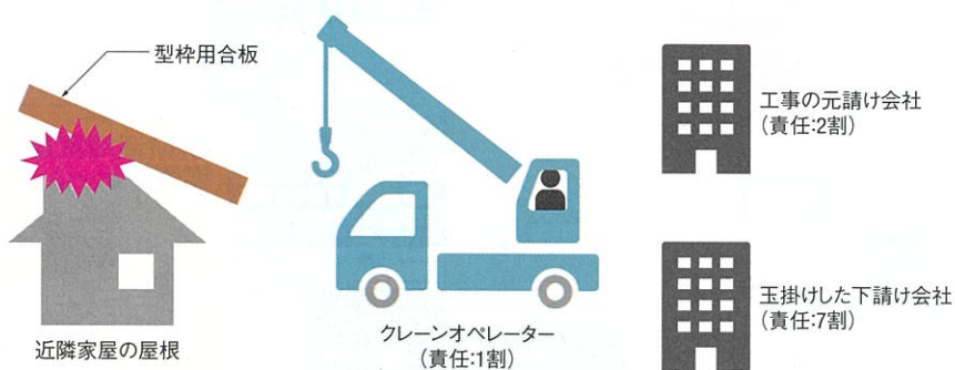
資料1 ■ 吊り上げた合板を隣家の屋根に落とした
