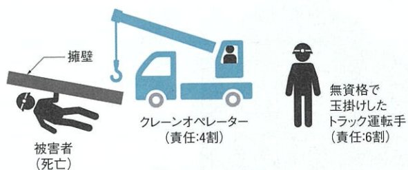
コンクリート擁壁を現場に搬入したトラックの運転手が無資格でクレーンに玉掛け。オペレーターは擁壁を別の作業員の上に落とし、死亡させた
